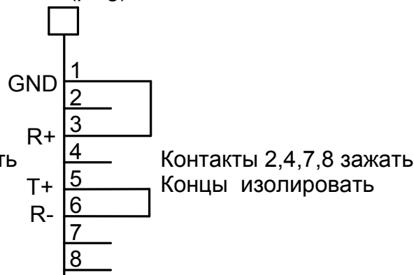
Заглушка "CL20mA" 4-проводный вариант RJ45 (plug)
