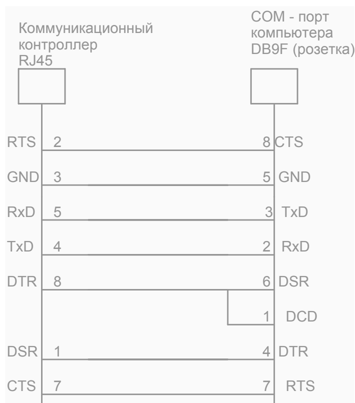
Рис 2. Кабель для подключения коммуникационного контроллера к COM-порту компьютера по интерфейсу RS232
